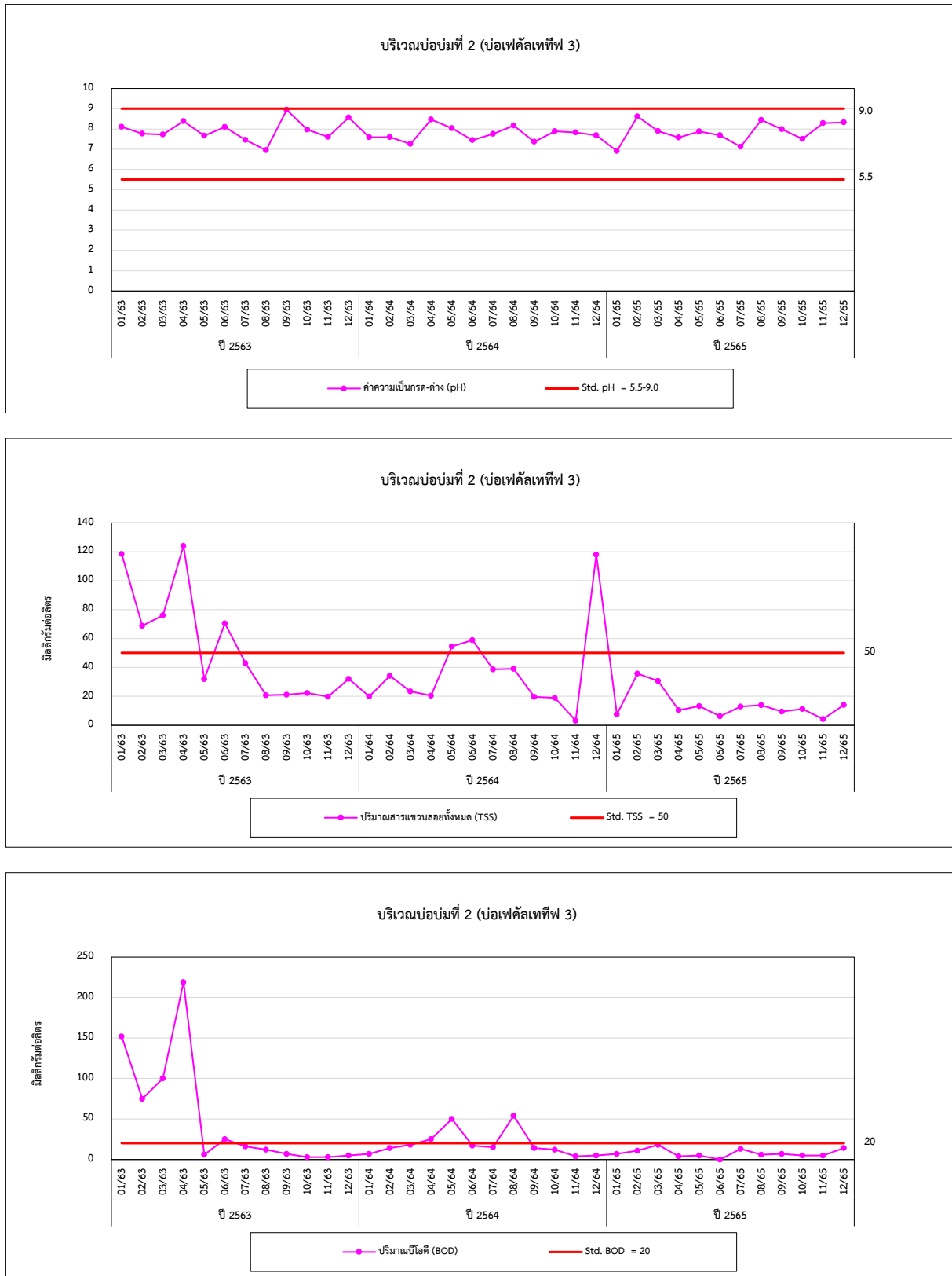
รูปที่ 4.4-1 กราฟเปรียบเทียบผลการตรวจวัดคุณภาพน้ำทิ้ง บริเวณบ่อบ่มที่ 2 (บ่อเฟคัลเททิฟ 3) ระหว่างปี 2563-2565
